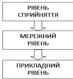
Рис. 1. Трирівнева архітектура IoT
