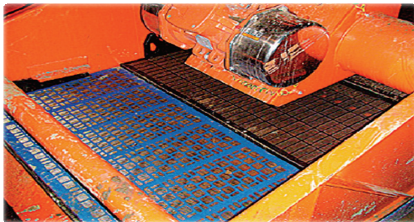
Рис. 6 Жорсткі касети на пластиковій (перший пакет за рухом матеріалу) і на металевій основі (другий пакет за рухом матеріалу), встановлені одночасно на вібриситі «Пульсар» під час промислових випробувань
