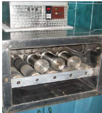
Rys. 3. Piec obrotowy rollen oven
