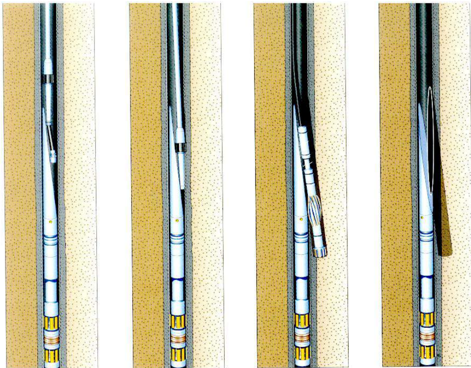
Рис. 1. Послідовність прорізання «вікна» в обсадженому стовбурі при використанні клина-відхилювача
