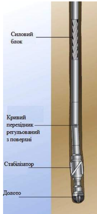
Рис. 5. Керований гвинтовий вибійний двигун
