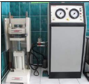
Fot. 5. Maszyna wytrzymałościowa Model 4207 firmy Chandler pozwala na oznaczenie wytrzymałości na zginanie, ściskanie, rozciąganie i przyczepności kamienia cementowego do różnych materiałów. Urządzenie pozwala wywierać na próbkę nacisk do 180 kN. Jest to metoda niszcząca badaną próbkę.
