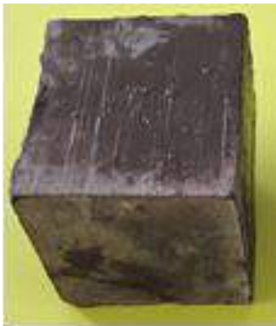
Fot. 7 Prostopadłościan o wymiarach 2 x 2 x 2 cale sporządzony z zaczynu cementowego nr 2 do badania mechanicznej wytrzymałości na ściskanie (czas hydratacji 7 dni).
