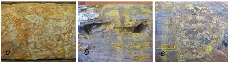
Рисунок 2 – Зовнішній вигляд НКТ, уражених різними видами корозії
