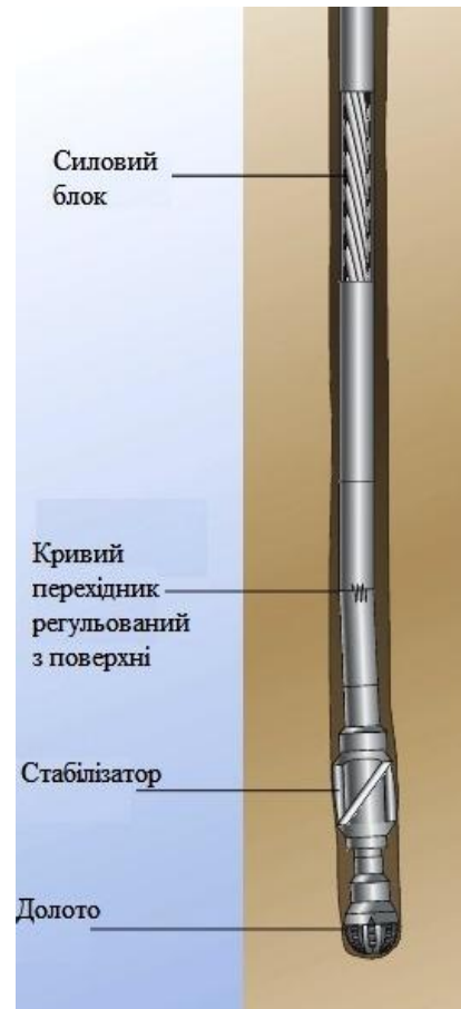
Рис. 5. Керований гвинтовий вибійний двигун
