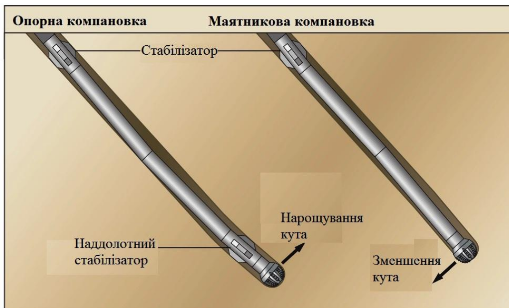
Рис. 3. Використання опорної та маяткової КНБК для зміни нахилу свердловини
