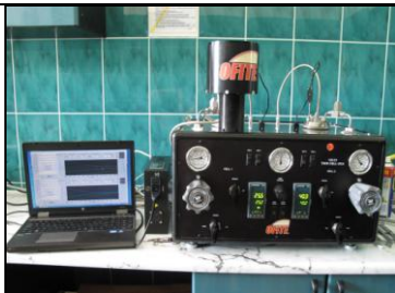
Fot. 4. Ultradźwiękowy Analizator Cementu Model 120-51 z modułem SGSM Model 120-53 firmy Ofite poprzez zmiany szybkości sygnału akustycznego, umożliwia wykonywanie ciągłych, nieniszczących badań wytrzymałości na ściskanie w funkcji czasu zaczynów i kamieni cementowych w warunkach otworopodobnych. Urządzenie SGSM mierzy statyczną odporność żeluz na ścinanie podczas pomiaru poprzez okresowy obrót łopatek wirnika. Maksymalna temperatura pracy 204°C, maksymalne ciśnienie – 34,5 MPa.
