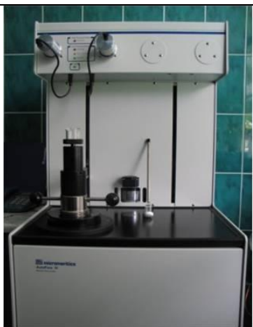
Fot. 6. Porozymetr rtęciowy firmy MicroMetrics umożliwia pomiar parametrów stwardniałego zaczynu uszczelniającego takich jak: - procentowa porowatość, - całkowita objętość porów, - średnia średnica porów, - przepuszczalność, - rozkład porów (mezopory i makropory), - gęstość szkieletowa. Znajomość tych parametrów pozwala na modyfikacje zaczynów uszczelniających w celu wytworzenia maksymalnie zagęszczonej matrycy powstałego kamienia cementowego.
