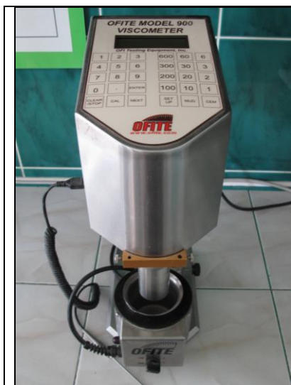
Fot. 1. Wiskozymetr Model 900 firmy Ofite umożliwia bezpośrednie określenie zależności pomiędzy prędkością ścinania cieczy a występującym naprężeniem stycznym pozwalając ba obliczenie lepkości plastycznej, granicy płynięcia i wytrzymałości strukturalnej. Dzięki podgrzewanemu kubkowi możliwe jest wykonywanie pomiarów w podwyższonej temperaturze (do 90°C).
