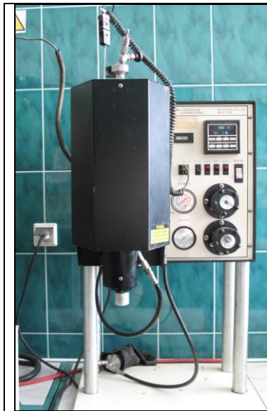
Fot. 3. Prasa filtracyjna Model 7120 firmy Chandler umożliwia szybkie i bezpieczne wykonanie pomiaru filtracji. Urządzenie pozwala na pomiary w warunkach otworopodobnych w temperaturze do 230°C i przy ciśnieniu do 14 MPa.
