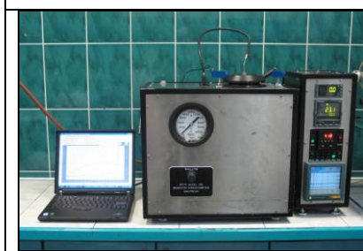
Fot. 2. Konsystometr ciśnieniowy polowy Model 130 firmy Ofite stosowany jest do pomiaru czasu gęstnienia w warunkach otworopodobnych, tj. w temperaturze i ciśnieniu panującym na dnie otworu wiertniczego. Konsystometr rejestruje w sposób ciągły konsystencję zaczynu cementowego, co pozwala zaobserwować początek – 30 Bc i koniec – 100 Bc czasu gęstnienia. Maksymalna temperatura badania ok. 200°C, maksymalne ciśnienie – ok. 110 MPa.
