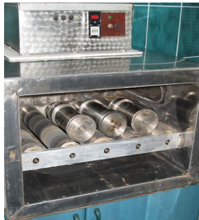
Rys. 3. Piec obrotowy rollen oven
