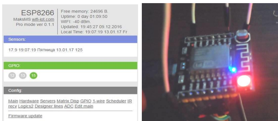
Рис. 11. Відповідність команди «15» веб-інтерфейсу синьому кольору індикатора контролера
