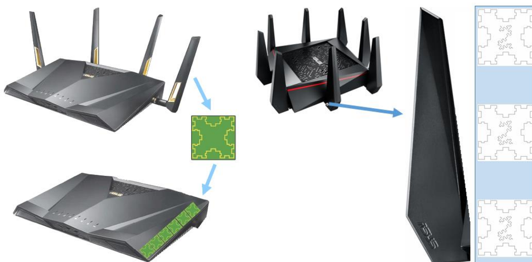
Рис. 12. Варіант заміни антенного елемента для розширення можливостей роутерів з MU-MIMO на прикладі конструктивів Asus RT-AX88U і RT-AC5300
