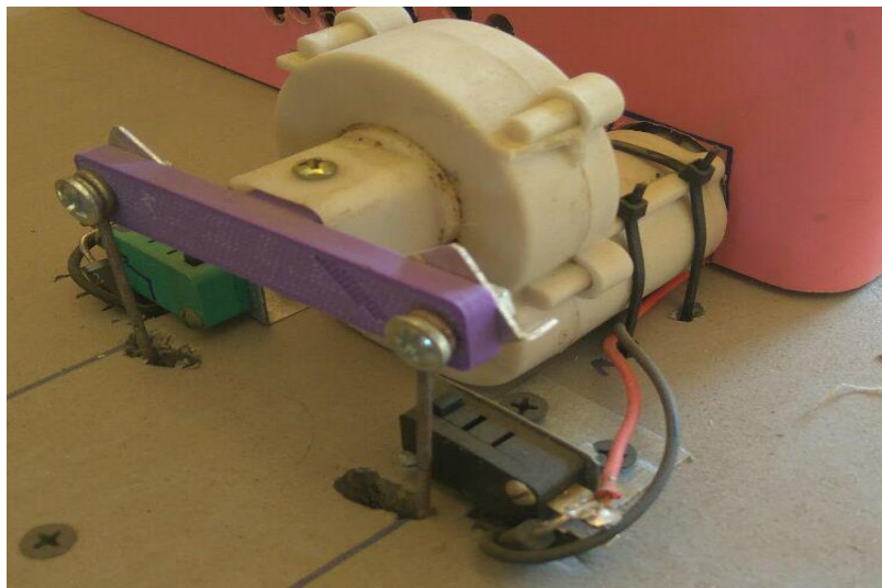
Рис. 4. Система перевероту яєць з кінцевими вимикачами
