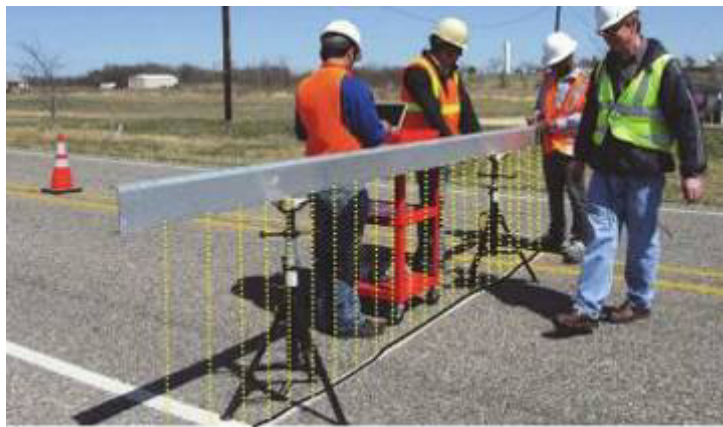
Рисунок 6 – Вимірювання колійності з використанням лазерної системи Leica
