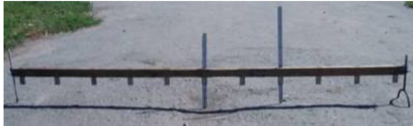
Рисунок 7 – Вимірювальна рейка з багатьма вимірювальними щупами
